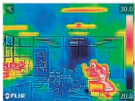
冷房時、画像中央のPSHR-Cの中を冷水が循環することでオフィス全体が涼しい環境に保たれている。(サーモグラフィ：2022/8/31 撮影)
